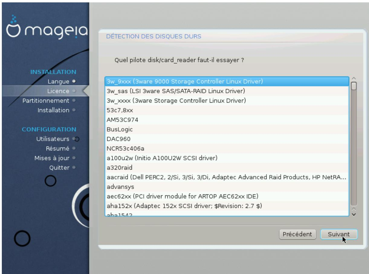
DrakX détecte habituellement les disques durs correctement. Il peut cependant échouer dans la détection de certains contrôleurs SCSI anciens et en conséquence être incapable d'installer les pilotes requis.
